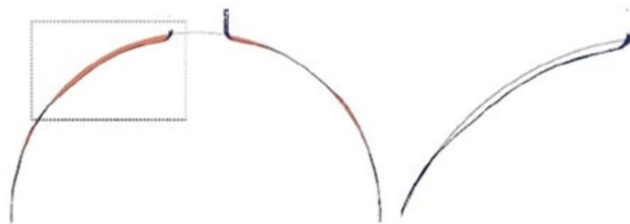
(c) Analisi di un profilo di sezione. Analisi delle deviazioni tra la superficie di rilievo e semisfera analitica.
