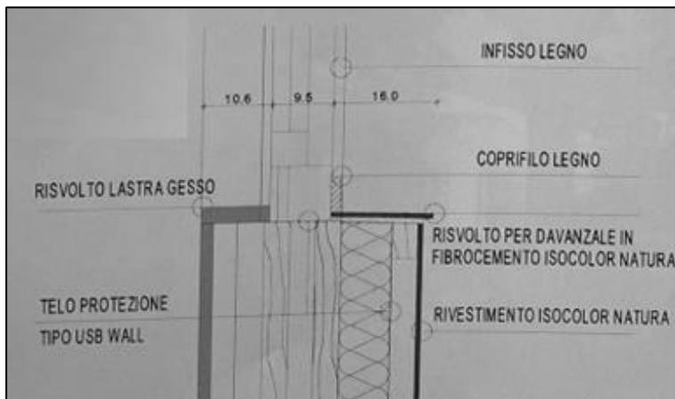
Figura 46 - Particolare costruttivo finestra-parete
