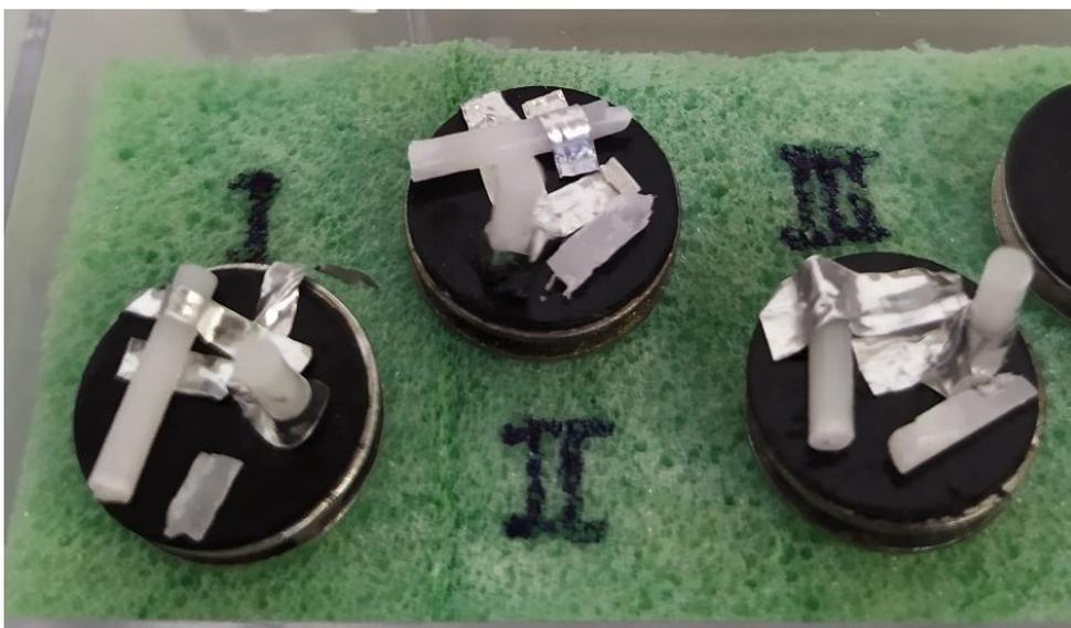
*Figura 2.12 – campioni per l'osservazione al microscopio elettronico*
