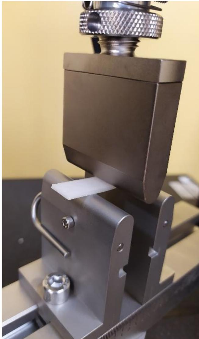
*Figura 2.11 – sistema per la prova a flessione a 3 punti*
