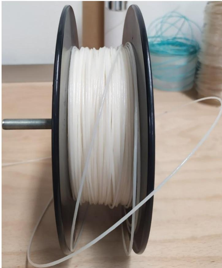
*Figura 2.3 – filamento della miscela PLA60/PBS40 avvolto sul winder*
