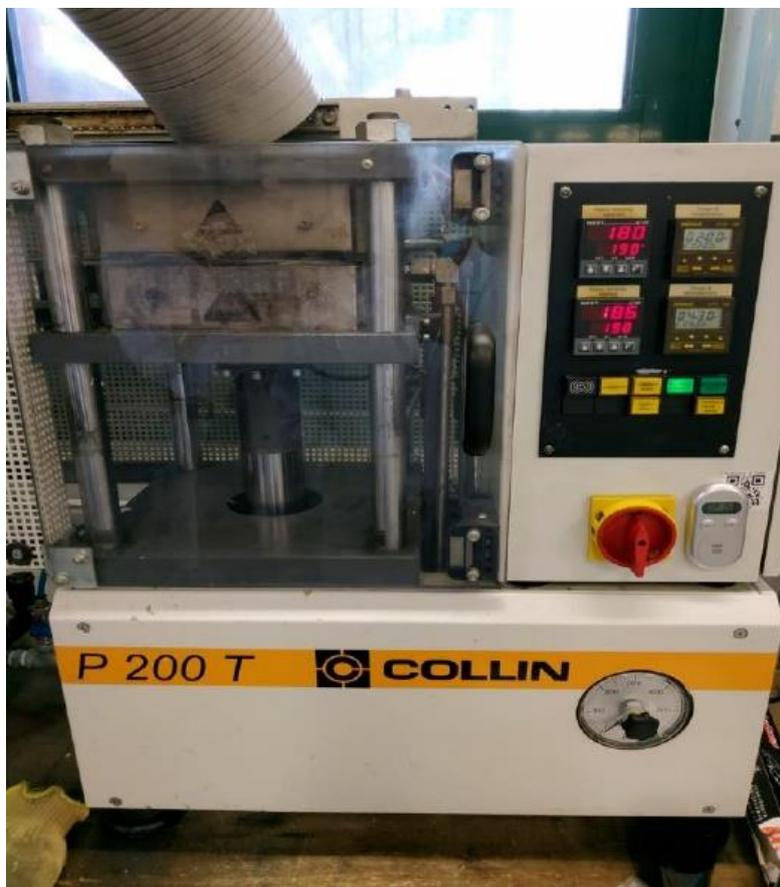
*Figura 2.8 – pressa P200T per la stampa a compressione*
