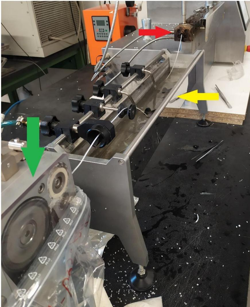
**Figura 2.1** – sistema di estrusione, raffreddamento e pellettizzazione delle miscele
