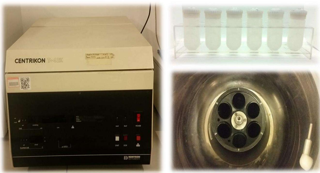
Figura 2.7 Centrifuga Centrikon T-24 K utilizzata con dettaglio delle provette e del sistema di alloggiamento refrigerato
