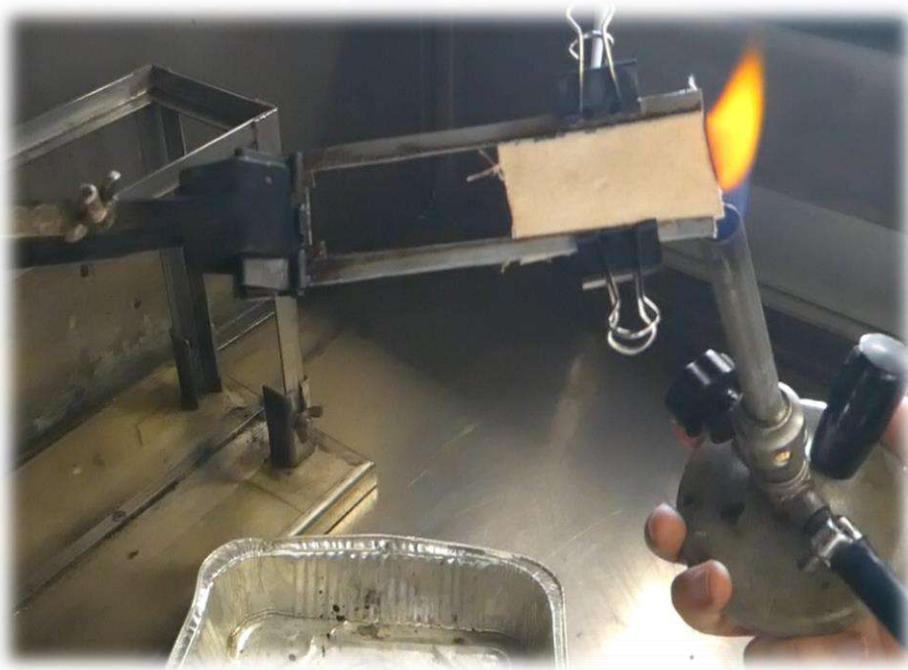
Figura 2.16 Test di infiammabilità, dettaglio dell'innesco del provino di tessuto rivestito
