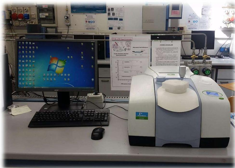
Figura 2.13 Spettroscopio ATR utilizzato, modello *Frontier* della *PerkinElmer*
