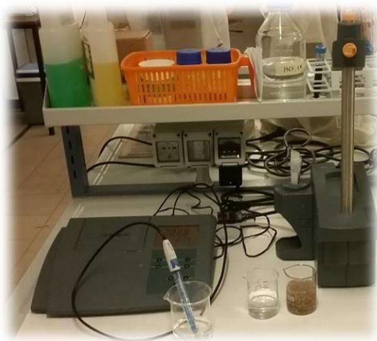
Figura 2.2 pH-metro utilizzato, modello Inolab® pH 730
