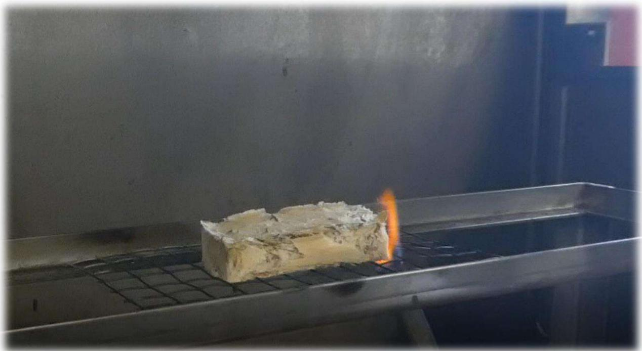
Figura 2.17 Test di infiammabilità condotto su schiuma di Alginato + BSG
