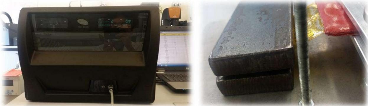
Figura 2.15 Hot disk modello TPS 2500S utilizzato e dettaglio del contatto tra il sensore, i provini e i supporti metallici
