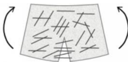
Figura 22. Provino fibrorinforzato sottoposto a flessione
