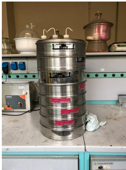
Figura 19. Setacci impilati con al vertice il setaccio con dimensione della maglia maggiore
