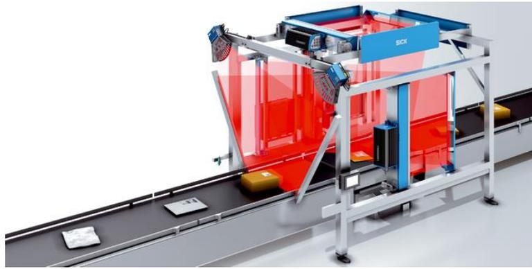
Il pacco una volta superato il lettore è identificato dal sistema, il quale nello step successivo applicherà tramite un'etichettatrice automatica, la giusta etichetta.
