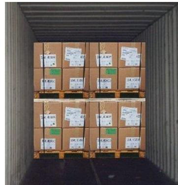
Come si può notare, la metodologia Floor loading permette di ottimizzare gli spazi e pertanto di caricare più merce all'interno del container. Inoltre, caricando sui pallet molto spesso in caso di merce non regolare o fuori sagoma, ovvero con dimensioni superiori a quelle del pallet, gli spazi non sfruttati sono molto più evidenti.
