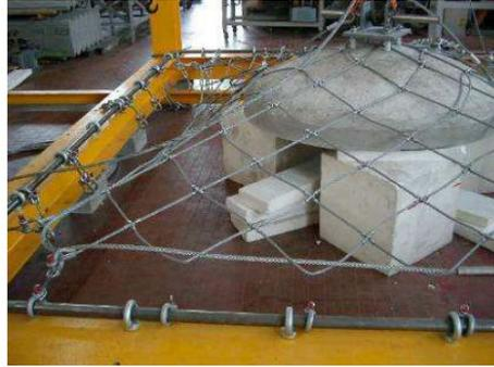
Figura 3.17 – Apparecchiatura utilizzata per la prova a punzonamento (Boneti & Galimberti 2004)
