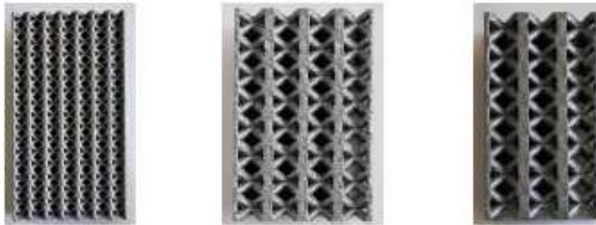
Figure 44 Provini BCCZ in AlSi10Mg con taglia di cella 3mm, 5mm e 7mm
