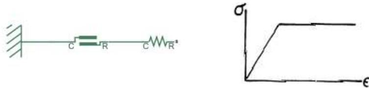
Figure 20 Modello Prandtl come visualizzato in Simulink
