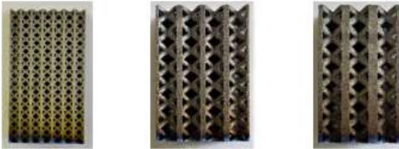
Figure 59 Provini BCCZ in Ti6Al4V con taglia di celle 3mm, 5mm e 7mm
