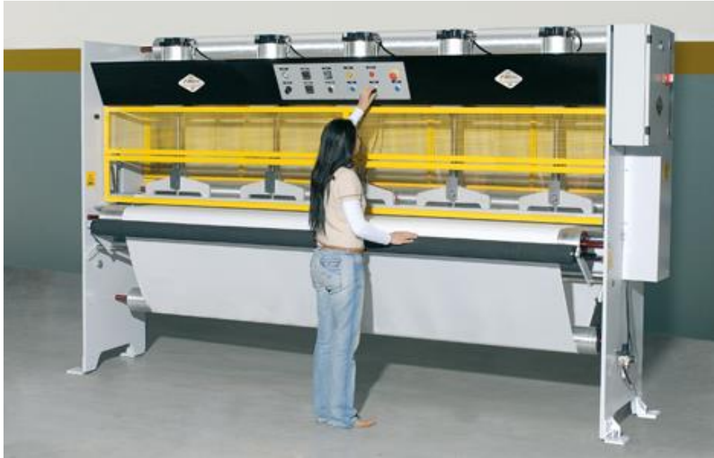
Figura 17: Esempio di macchina per termosaldatura tessile (Modello: AWE ARROW) (Source: https://www.zparrow.it/termosaldatura-tessuti-macchine-per-termosaldatura-tessile-presse-giunzione-a-caldo/caratteristiche-tecniche-e-posizionamento/ )
