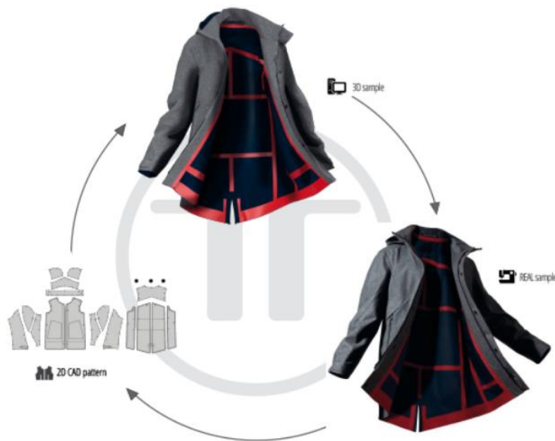
Figura 10: Ciclo di realizzazione di un giubbotto utilizzando la modellazione 3D e 2D (Source: https://www.pattern.it/pattern-torino-prototipazione-3d )
