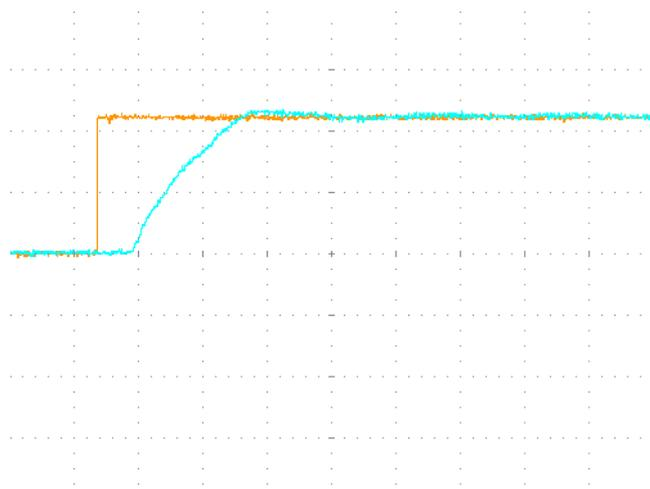
Figura 5.28. Modello dinamico con rampa 2s e  $V_a=440V$  (1s/div)
