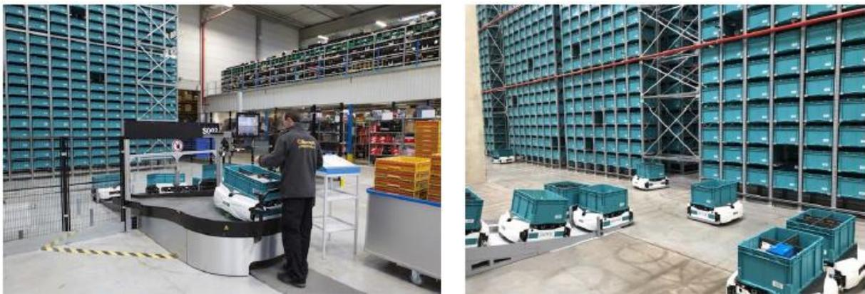
*Figura 2.8: Applicazione in magazzino dei robot Skypod di Exotec (Carlin, 2021)*
