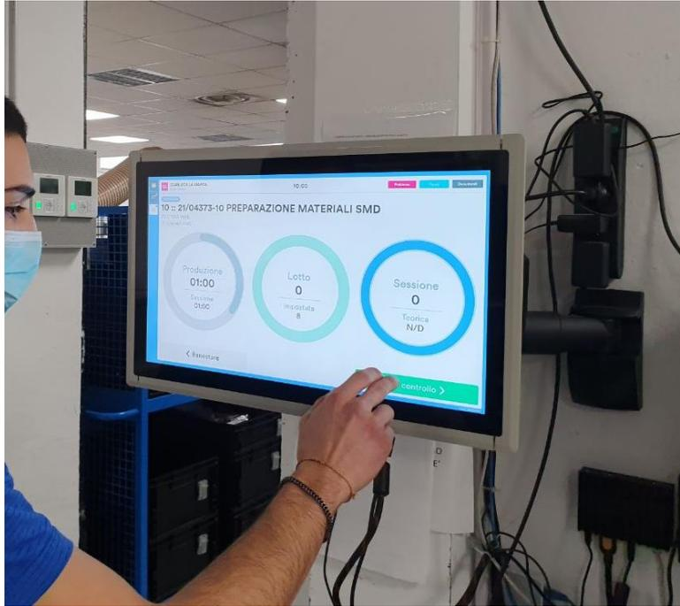
*Figura 3.6: HMI con interfaccia operatore di Agile Factory applicato in Next*
