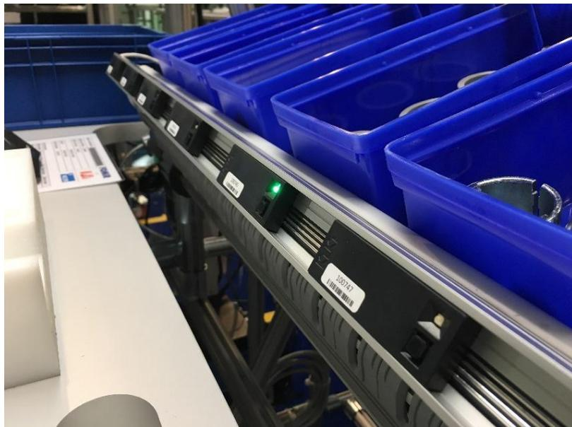
*Figura 2.10: Esempio di sistema pick to light [25]*
