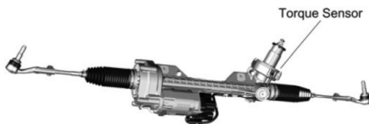
**Figura 2.9:** Collocazione inferiore della barra di torsione in [4]
