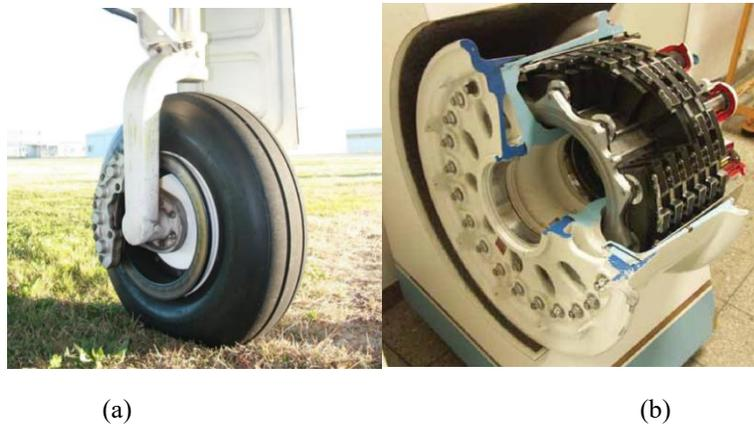
Figura 1.1 – Esempio di sistema frenante a disco singolo (a)<sup>[2]</sup> e multidisco (b)<sup>[3]</sup>
