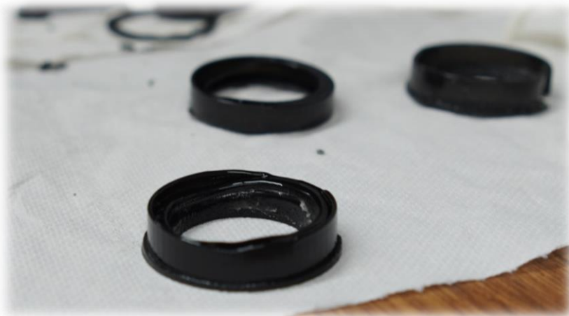
Figura 44 - guarnizioni difettate e danneggiate
