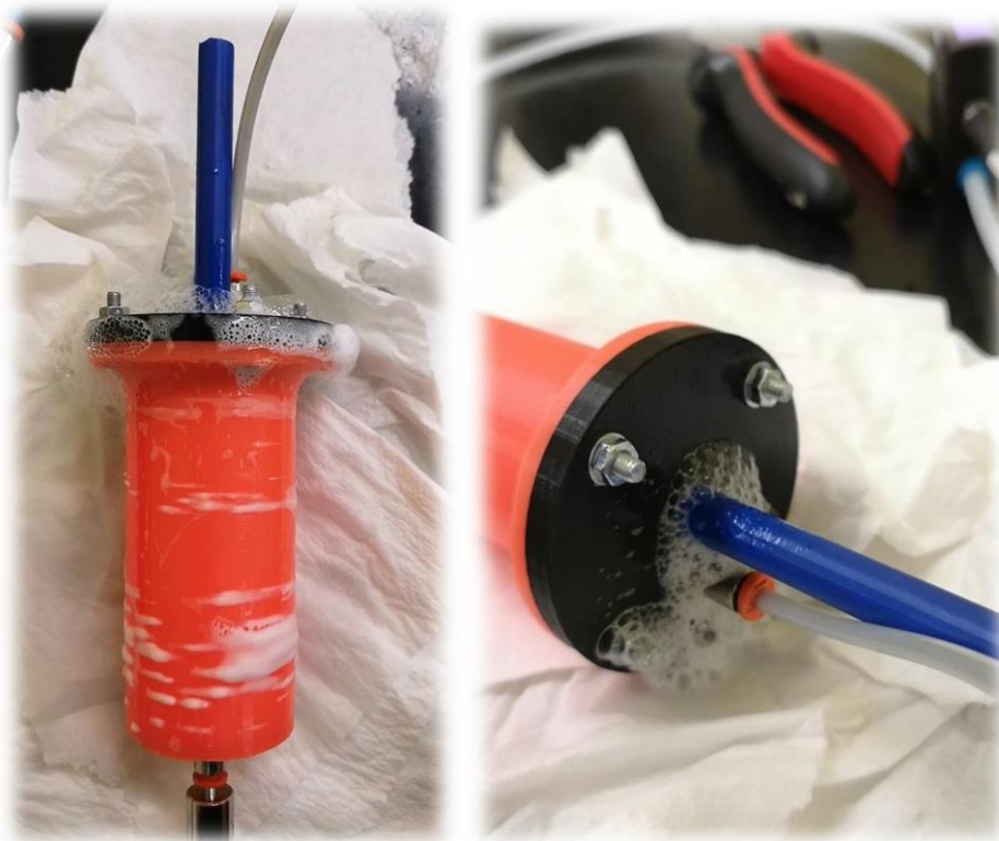
Figura 94 - Perdite attraverso la testata anteriore e la guarnizione attuatore 5
