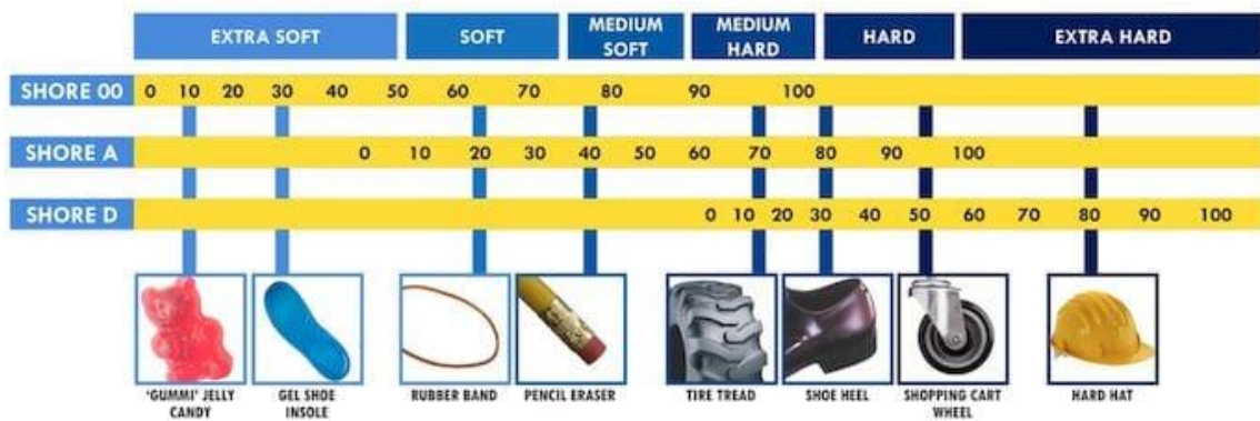
Figura 64 - Scala di durezza del TPU secondo ASTM D-2240
