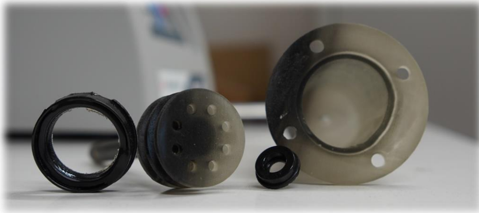
Figura 53 - Componenti stampati con Objet Prime non idonei
