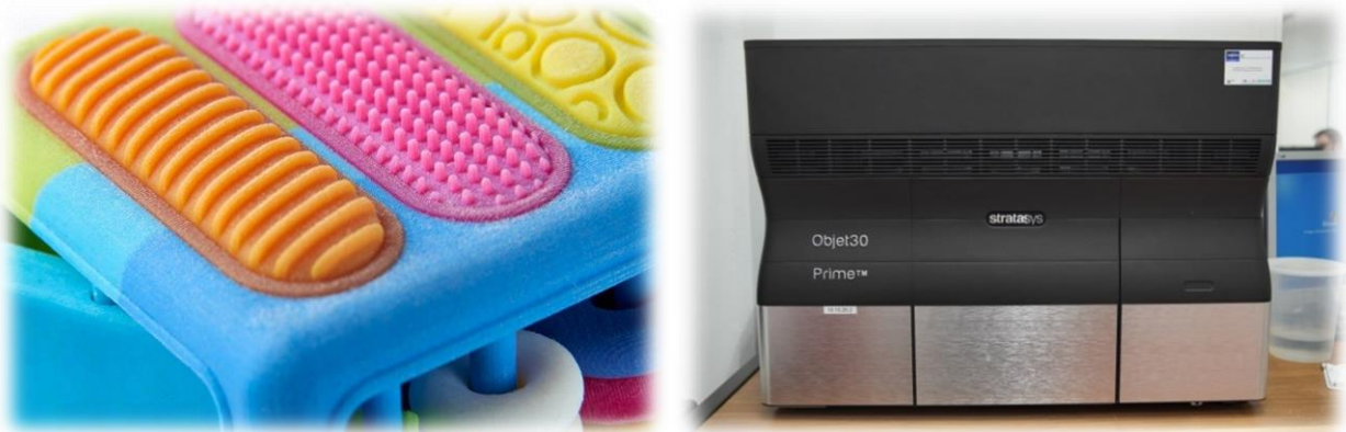
Figura 2 - Esempio di stampa multi-materiale a sinistra, Object Prime sita nel laboratorio IAM del Politecnico
