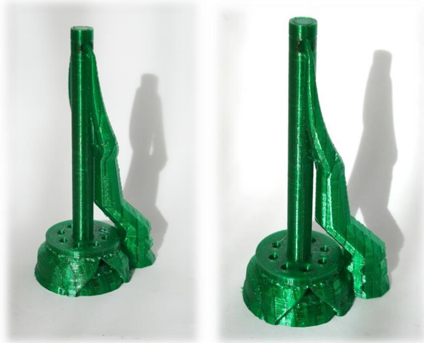
Figura 57 – pistone stampato prima della rimozione dei supporti
