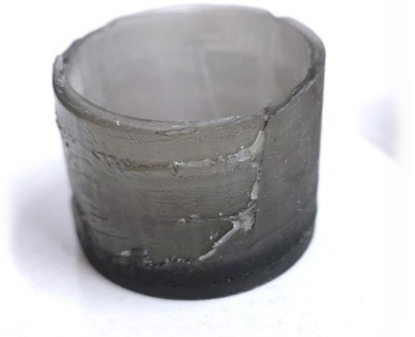
Figura 50 - provino cilindro h=35mm difettato
