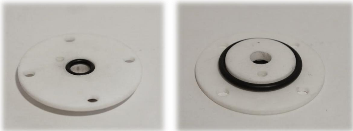
Figura 88 - Testata anteriore in Nylon PA12, parte inferiore con guarnizioni integrate
