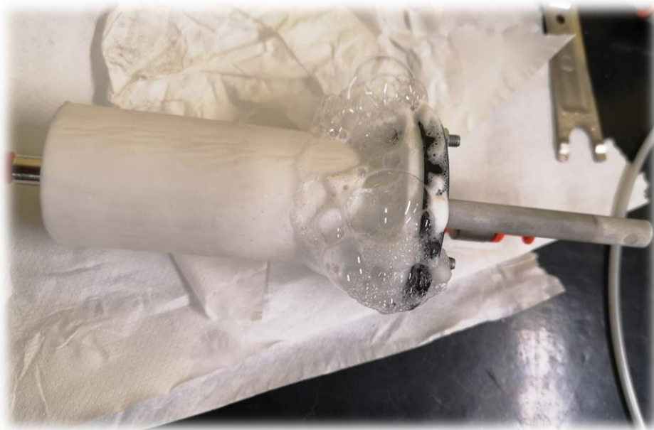
Figura 98 - Bolle d'aria nell'attuatore 7 dovute a perdite
