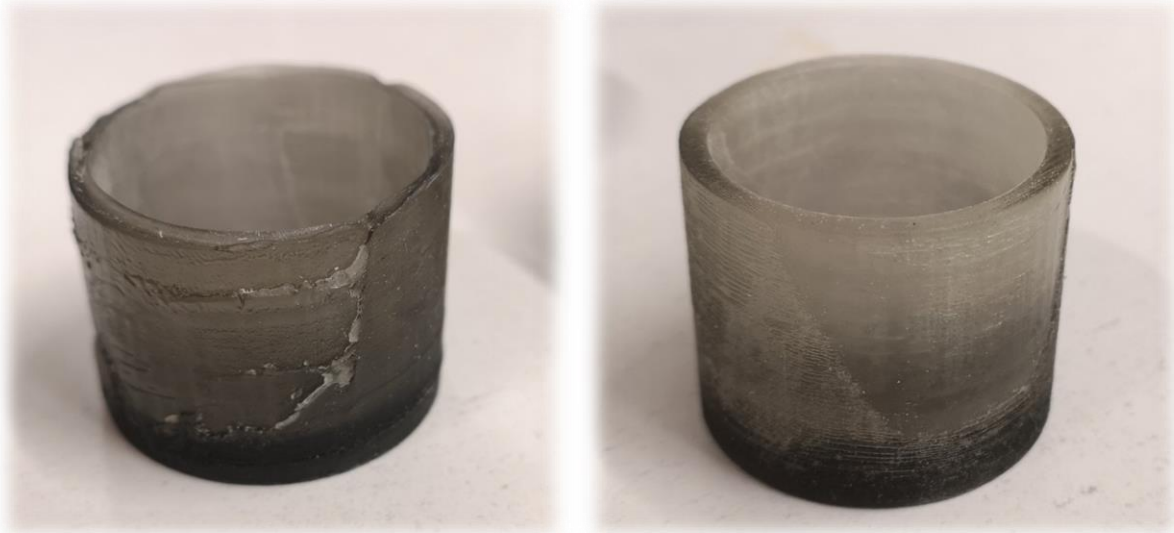
Figura 52 - Provini del cilindro. A sinistra qualità HQ, a destra qualità SQ
