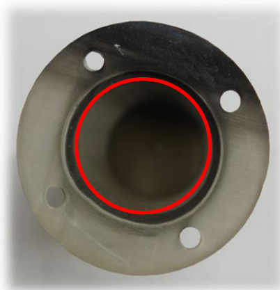
Figura 49 - errore di stampa, particolare della sezione circolare
