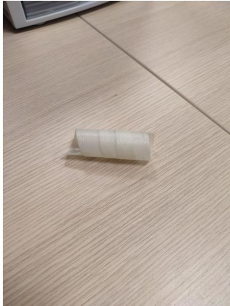
Figura 5.4: Configurazione avvolta di un prototipo con angoli sbagliati
