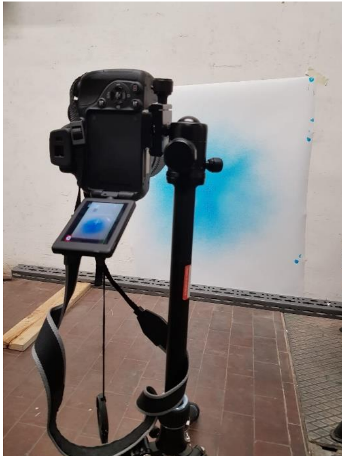
Figura 3.10-Operazione di acquisizione dei getti tramite fotocamera Fujifilm Finepix HS50EXR.
