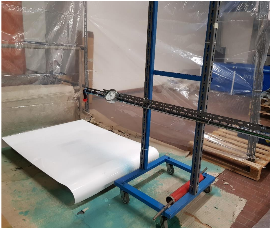
Figura 4. 7- Posizionamento del foglio per rilevare le caratteristiche del getto.
