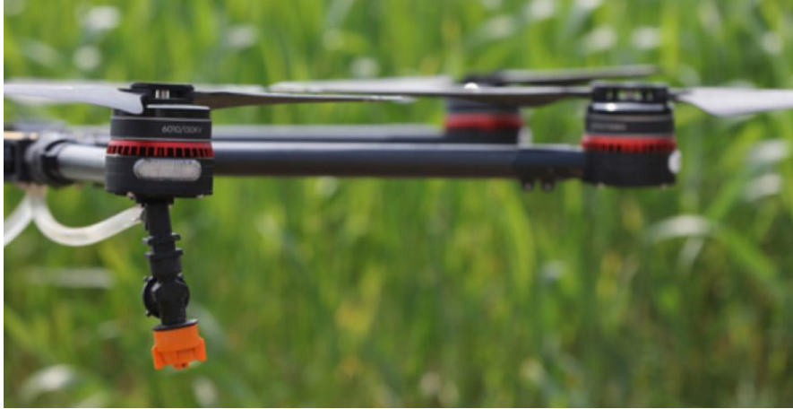
Figura 1.8- Drone DJI Agras MG-1: dettaglio ugello irroratore. Fonte: https://www.ildrone.net/prodotto/agras-mg-1-dji .
