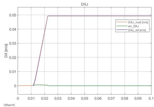
(d) Jack velocity with a ramp command=0.1 m/s
