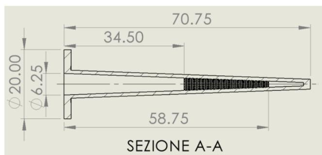
**Figura 2.4.** Cavità con rugosità [31]
