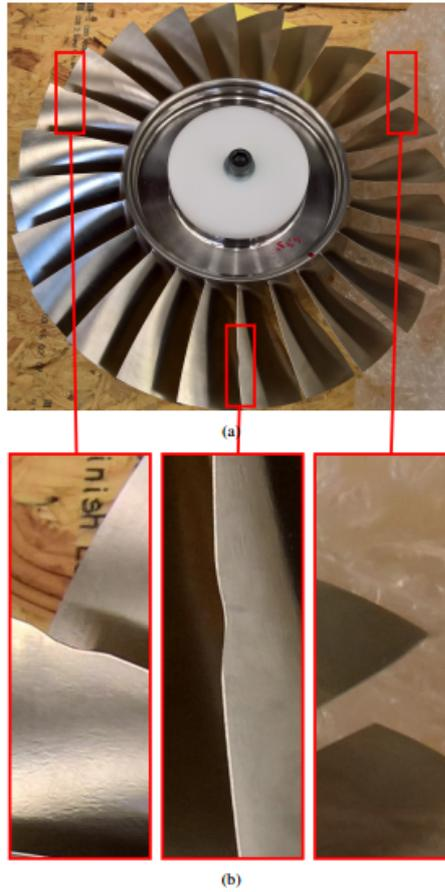
**Figura 2.4:** (a) Disco palettato con 3 pale riparate per *blending* e (b) dettagli dei *blend* sulle 3 pale [6]
