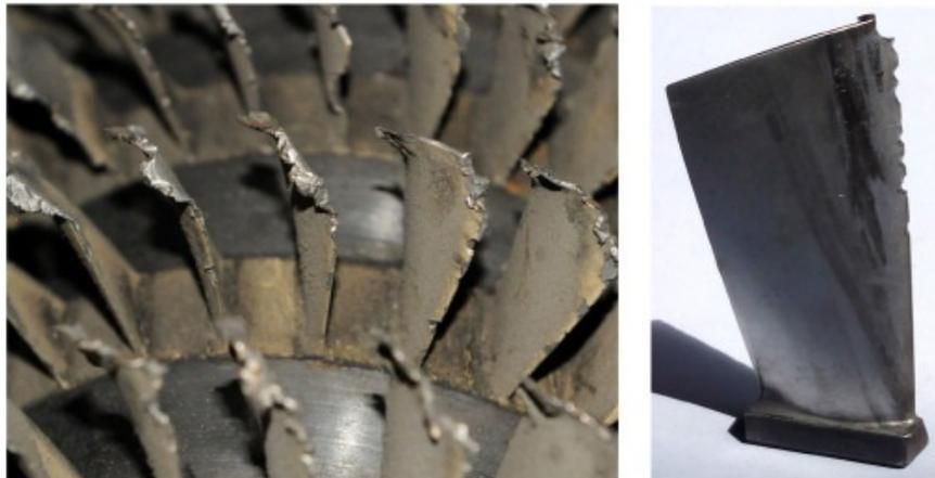
**Figura 1.1:** Esempi di dischi palettati danneggiati da impatti
