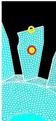
**Figura 4.15:** Nodo di applicazione della forzante (in rosso) e nodi di lettura della risposta (in giallo)
