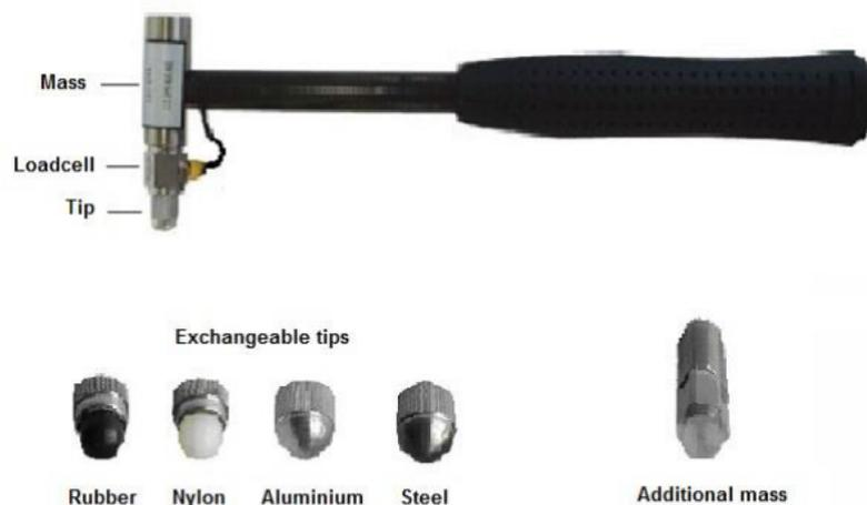
**Figura 5.2:** Esempio di martello strumentato con, in basso, le testine interscambiabili di varia durezza.
