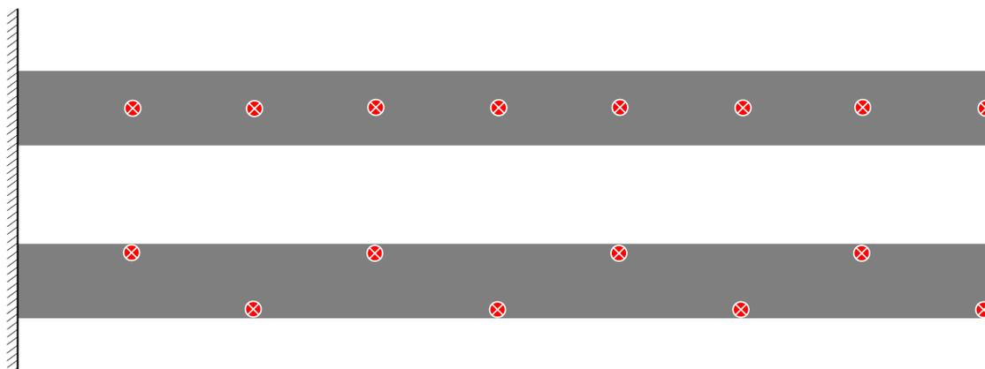
**Figura 5.5:** Posizionamento degli accelerometri in diverse prove sperimentali: in alto è il posizionamento rettilineo per l'individuazione dei solo modi flessionali; in basso è il posizionamento a Zigzag per i modi Flesso-torsionali.
