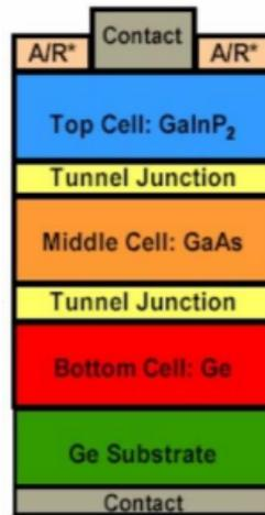
Figura 1.5: Rappresentazione di una cella a tripla giunzione
