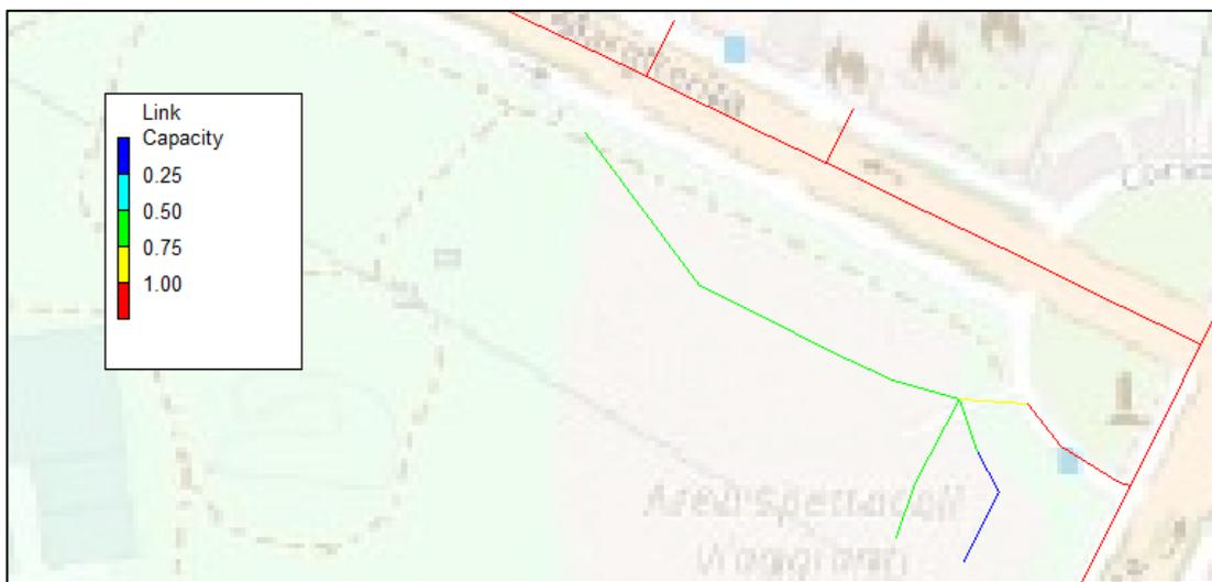
*Figura 73: Risposta della rete in ZONA 2 dopo la sostituzione dei collettori*
