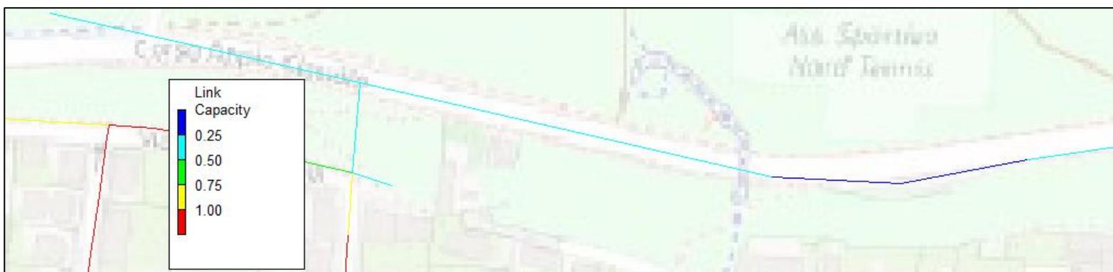
Figura 78: Risposta della rete in ZONA 1 dopo l'introduzione del collettore
