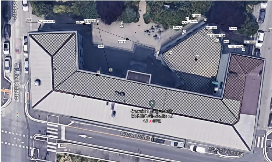
Figura 5.2- Modello SWMM relativo allo scenario post-intervento pilota
