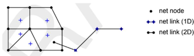
**Figura 41** Punti notevoli delle celle costituenti la mesh di calcolo in D-FlowFM (D-FlowFM User Manual, 2021)
