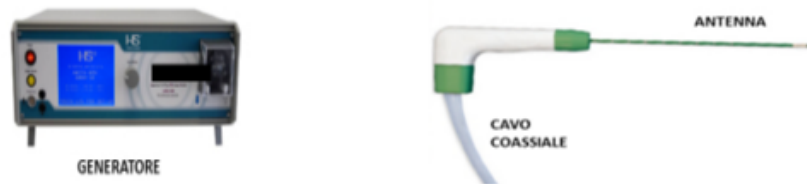
Figura 2.2. Strumentazione utilizzata nell'ablazione a microonde.
