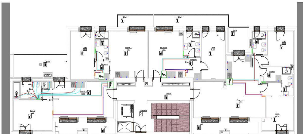
Figura 75: Posizionamento pompe di calore acqua-acqua negli alloggi
