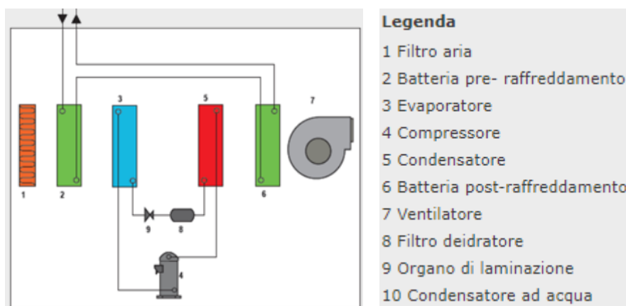
Figura 48: Schema di funzionamento deumidificatore [25]
