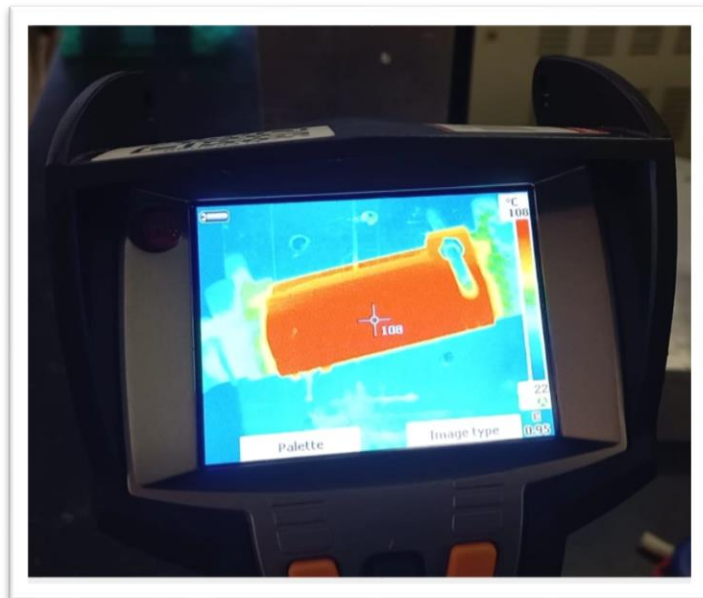
Figura 4.3: Termogramma del resistore durante la prova del 26 novembre 2021.
