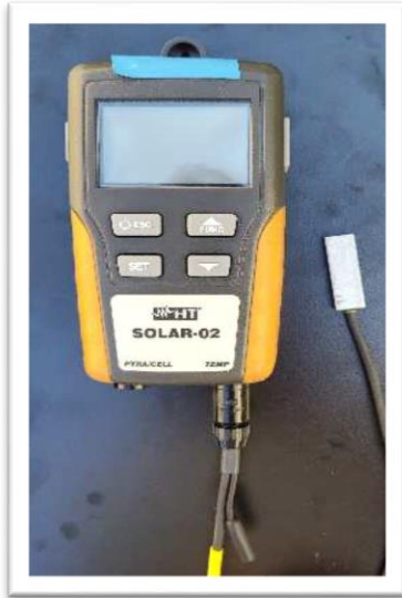
Figura 3.5: Sonda di temperatura HT-Solar02.
