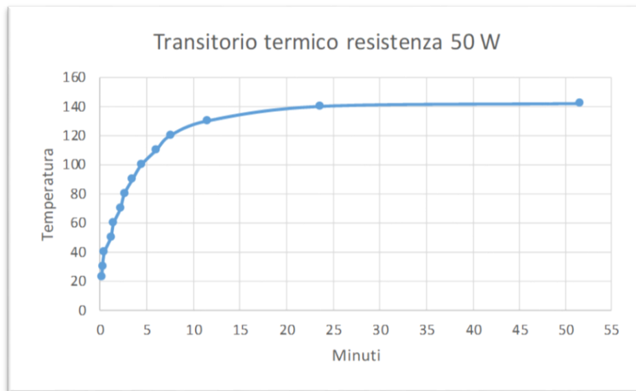
Figura 4.5: Transitorio termico – prova del 3 dicembre 2021.
