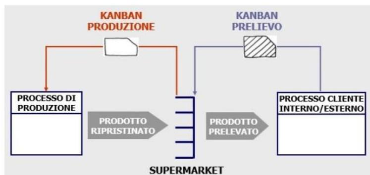
Figura 6: schema di funzionamento kamban
