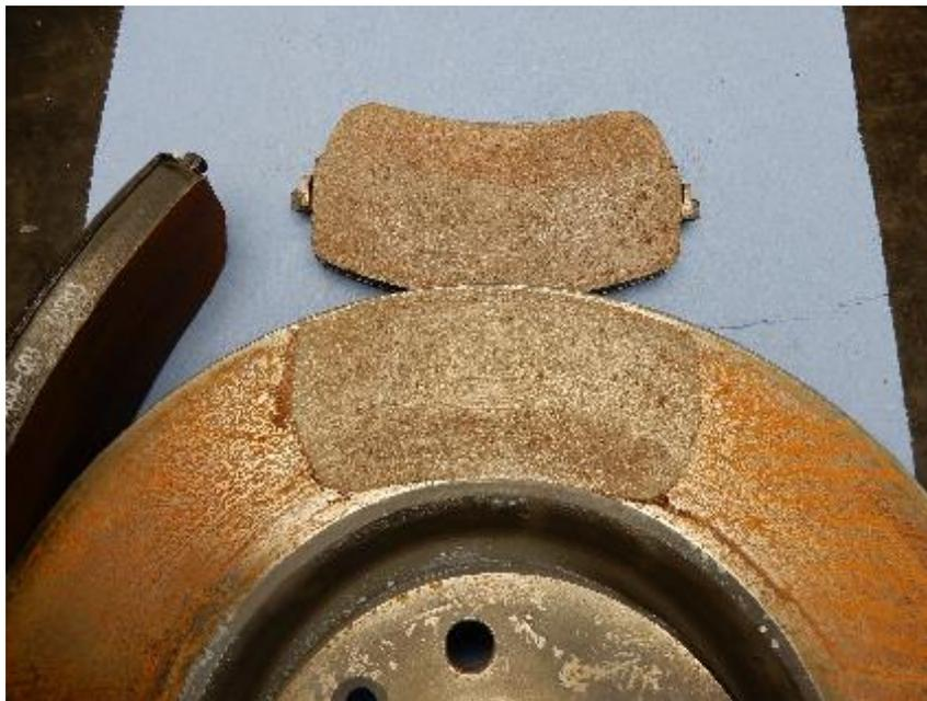
*Figura 8 Risultato di una prova di stiction effettuata su disco intero*
