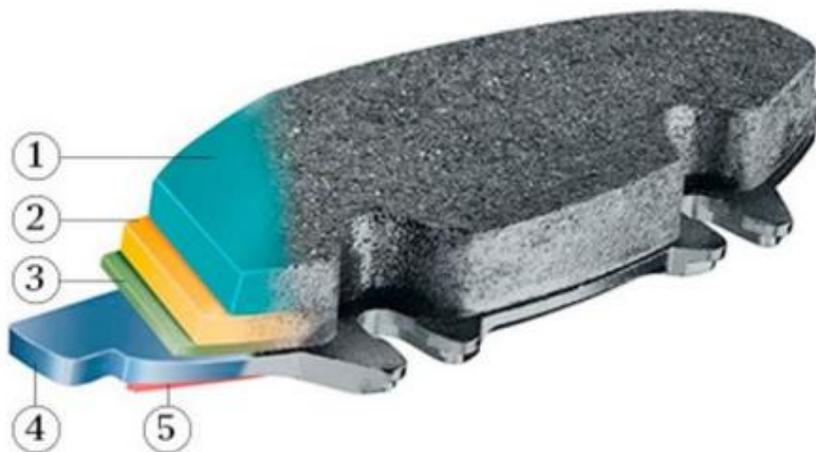
Figura 3 Schema struttura di pastiglia freno: 1) materiale d'attrito, 2) underlayer, 3) adesivo 4) supporto metallico, 5) shim antirumore [1]
