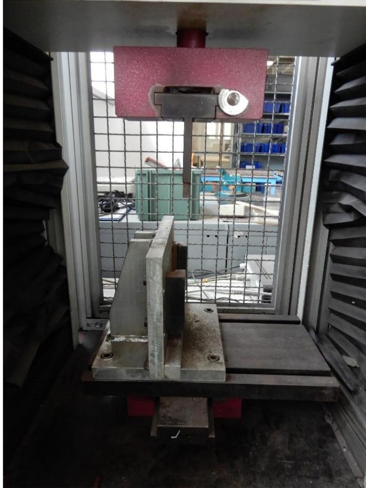
*Figura 16 Dettaglio del portacampione per il distacco*
