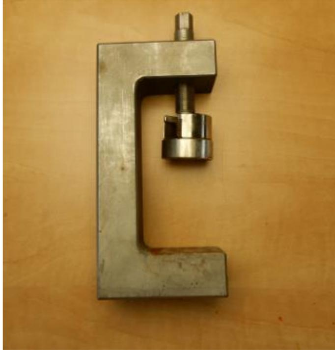
*Figura 14 C-clamp utilizzata nel setup sperimentale*
