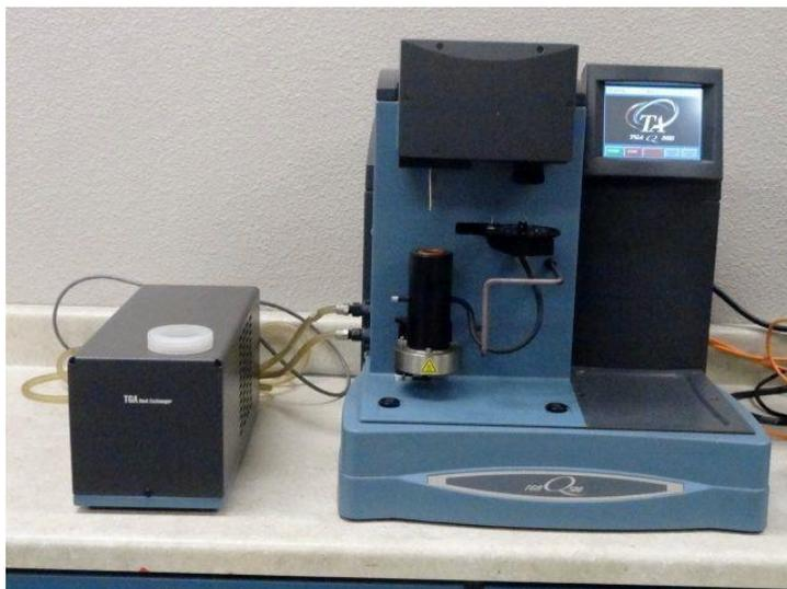
Figura 3.23: TGA Q500 utilizzata [58].
