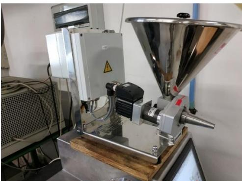
Figura 3.7: Dosatore gravimetrico utilizzato per il polimero il biochar
