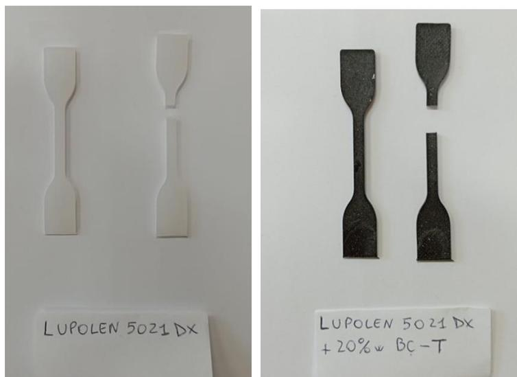
Figura 4.72: provini prima e dopo la prova a trazione: a sx in Lupolen e a dx in Lupolen+ 20%BC-T
