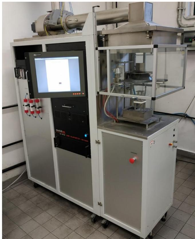
Figura 3.21: Cono calorimetro utilizzato
