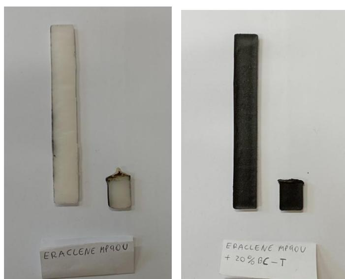
Figura 4.18: provini di Eraclene MP90U e Eraclene MP90U + 20%wt BC-T prima e dopo la prova.
