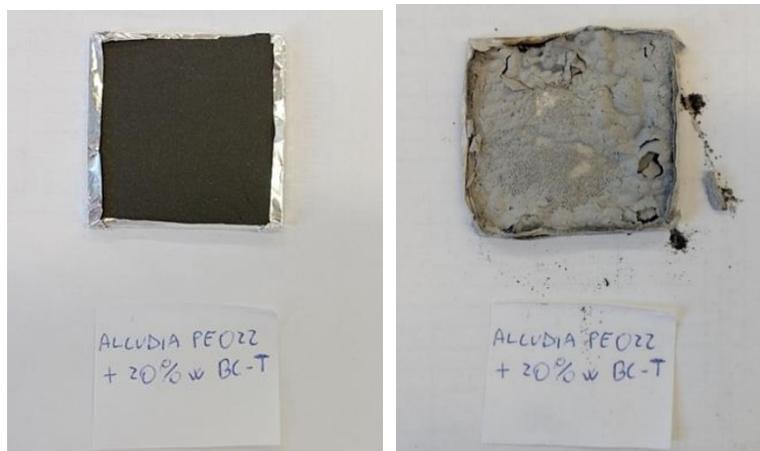
Figura 4.62: Campione prima della prova e residuo dopo la prova di Alcludia+ 20%wt BC-T
