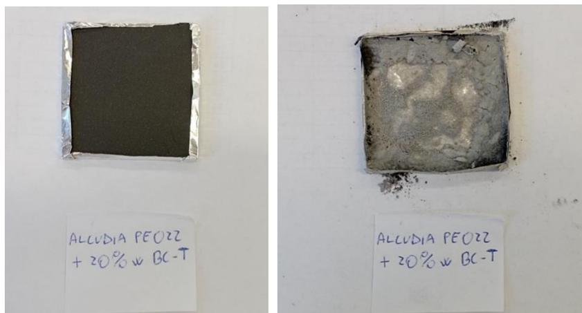
Figura 4.58: Campione prima della prova e residuo dopo la prova di Alcudia + 20%wt BC-T
