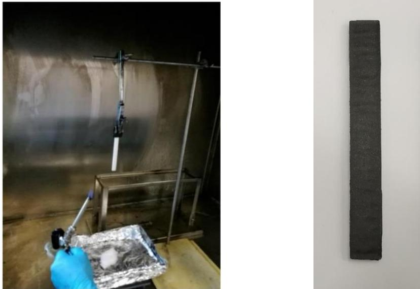
Figura 3.17: A sx: apparato sperimentale utilizzato; a dx: provino per la prova UL-94 VB.
