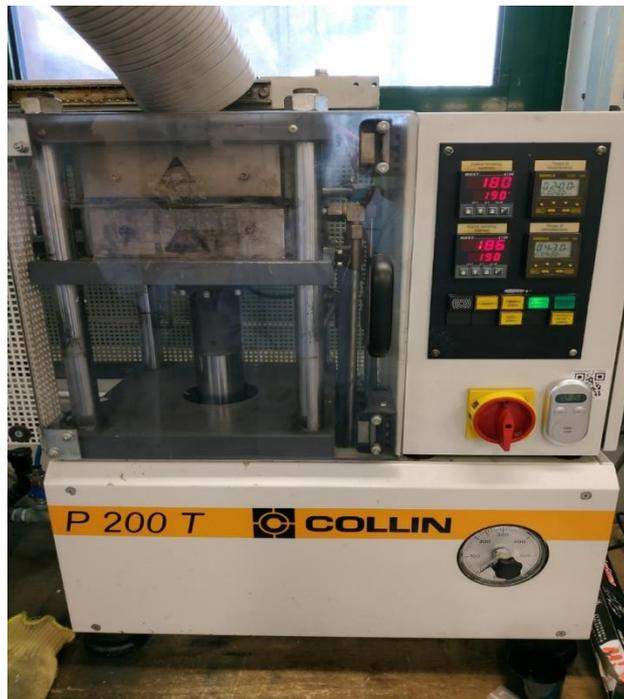
Figura 3.11: Pressa per stampaggio a compressione Collin P200T utilizzata.
