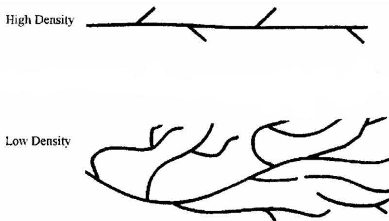
Figura 3.1: Strutture del polietilene [48]
