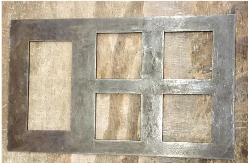
*Figura 3.12: Stampo per campioni con calorimetro.*
