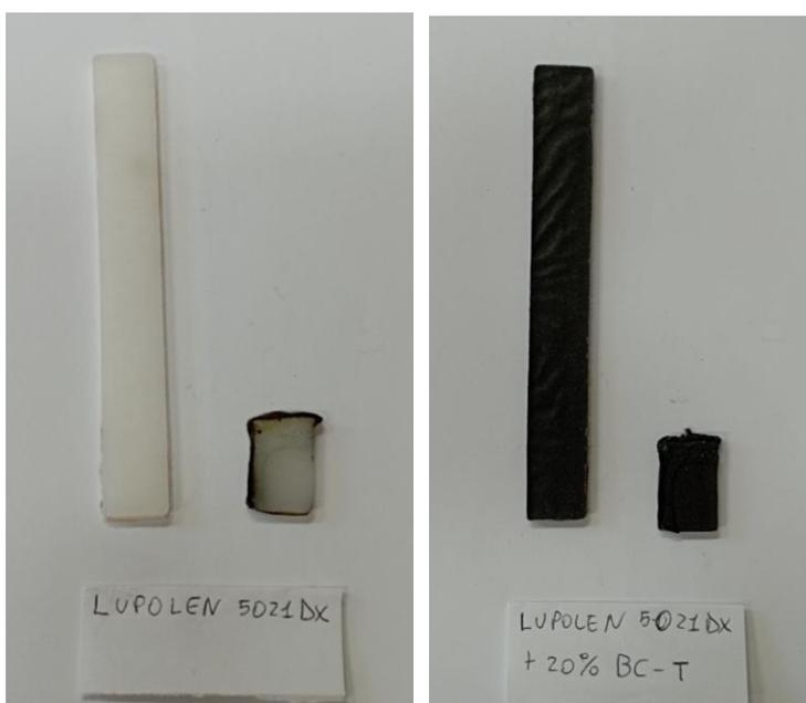
Figura 4.17: provini di Lupolen 5021DX e Lupolen 5021DX + 20%wt BC-T prima e dopo la prova.
