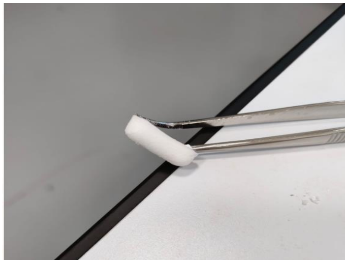
Figura 2.12 Compresse al 5% di mannitolo, ottenuta alla fine del processo di liofilizzazione.
