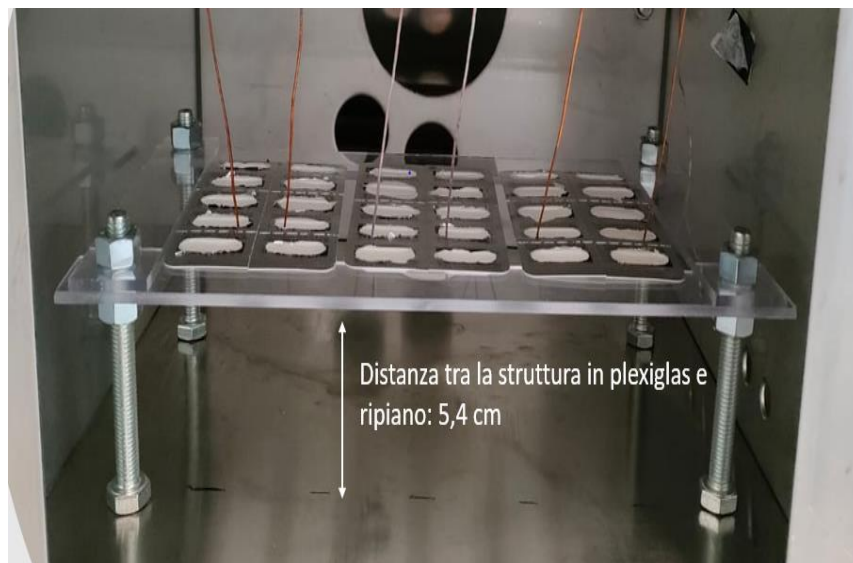
Figura 2.11 Configurazione CS: Blister sospeso massima altezza schermato.
