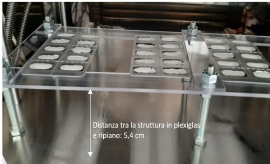
Figura 2.10 Configurazione C: Blister sospeso massima altezza.
