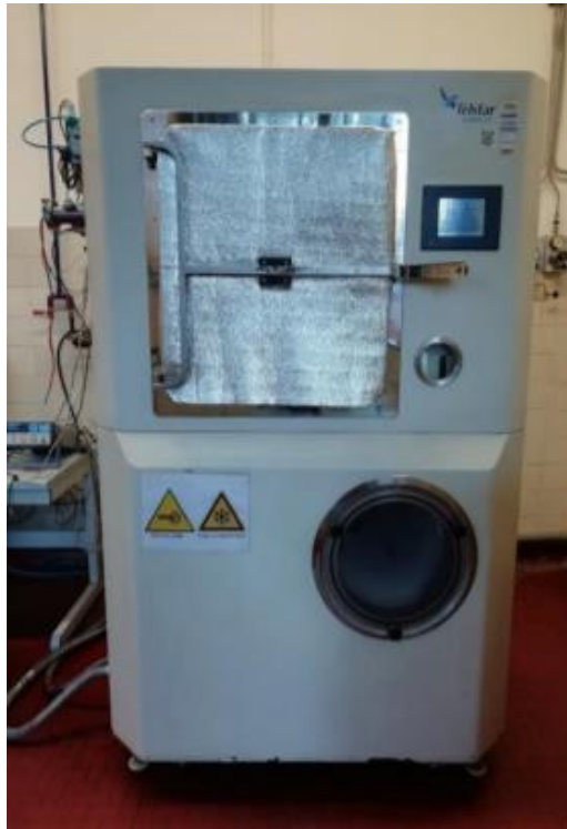
Figura 2.2 Liofilizzatore LyoBeta utilizzato per la conduzione degli esperimenti di questo progetto di tesi.
