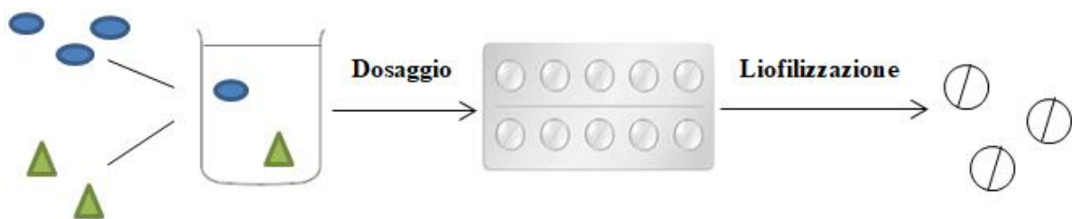
Figura 1.10: Rappresentazione del processo di produzione di compresse tramite liofilizzazione. La componente attiva del farmaco (rappresentata dai cerchi azzurri) e gli eccipienti (rappresentati dai triangoli verdi) vengono miscelati in soluzione acquosa; a seguire, avviene il dosaggio e la liofilizzazione con l'ottenimento delle compresse di interesse come prodotto finale.
