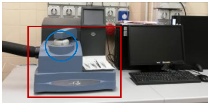
Figura 2.2: Strumenti utilizzati per l'analisi DSC: in particolare, nel riquadro in rosso è evidenziata la camera chiusa e, nel dettaglio circondato in azzurro, il punto di caricamento del campione (particolare interno in Figura 2.1).
