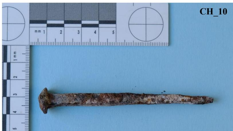
**Figura 2.11** Chiodo trattato con il protettivo remox, pretrattato con  $Cl^-$  ed esposto in camera umidostatica (CH\_10).
