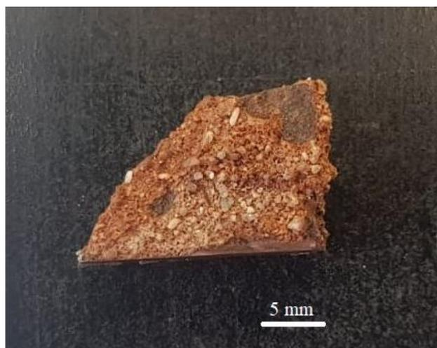
**Figura 2.3** Campione di riferimento in ferro ARMCO invecchiato artificialmente per un periodo di 4 mesi.
