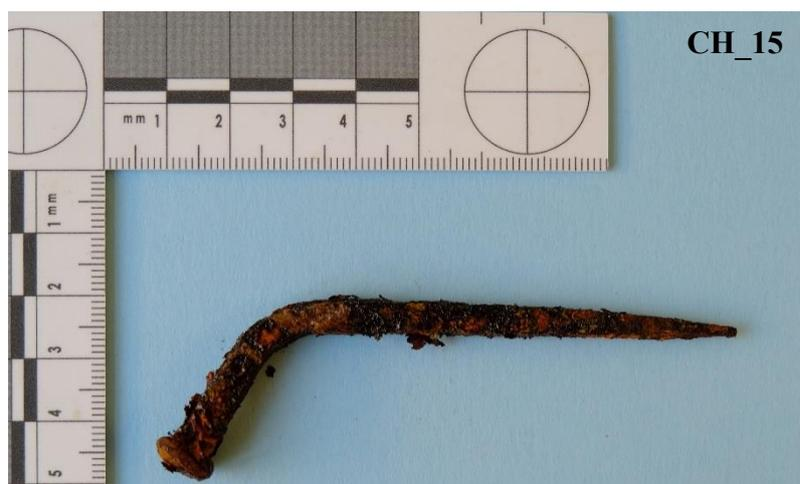
**Figura 2.16** Chiodo trattato tramite polimerizzazione di acrilati *in-situ* ed esposto in camera umidostatica (CH\_15).
