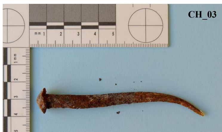
**Figura 2.6** Chiodo che non ha subito alcun trattamento protettivo, ma pretrattato con  $Cl^-$  ed esposto in camera climatica (CH\_03).
