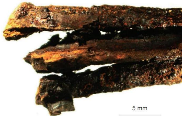
**Figura 1.9** Esempio di laminazione per formazione di akaganéite su un chiodo archeologico.
