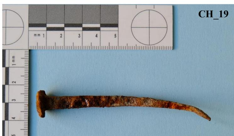
**Figura 2.7** Chiodo che non ha subito alcun trattamento protettivo, ma pretrattato con  $Cl^-$  ed esposto in camera umidostatica (CH\_19).
