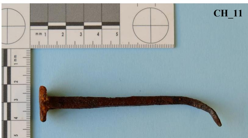
**Figura 2.12** Chiodo trattato con il protettivo rust oleum (CH\_11).
