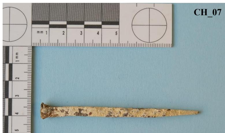
**Figura 2.9** Chiodo trattato con il protettivo metallay (CH\_07).
