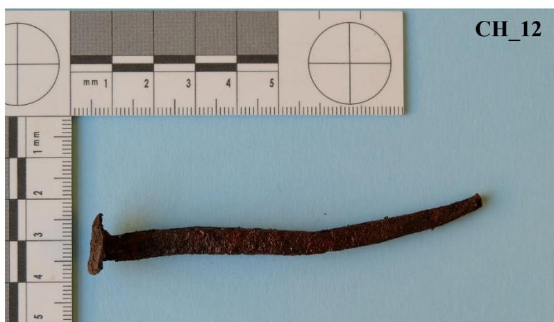
**Figura 2.13** Chiodo trattato con il protettivo rust oleum, pretrattato con  $Cl^-$  ed esposto in camera climatica (CH\_12).
