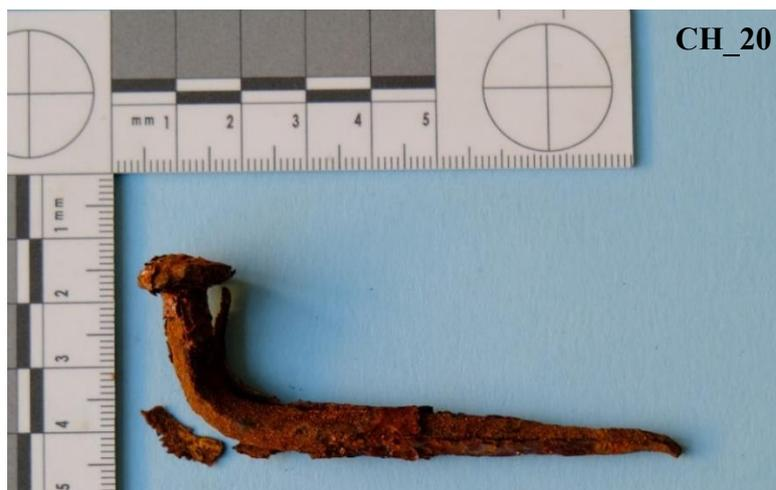
**Figura 2.17** Chiodo trattato tramite polimerizzazione di acrilati *in-situ* ed esposto in camera umidostatica (CH\_20).
