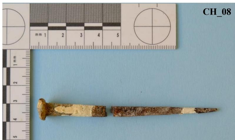
**Figura 2.10** Chiodo trattato con il protettivo remox (CH\_08).
