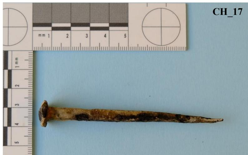
**Figura 2.15** Chiodo trattato con il protettivo ferox ed esposto in camera umidostatica (CH\_17).
