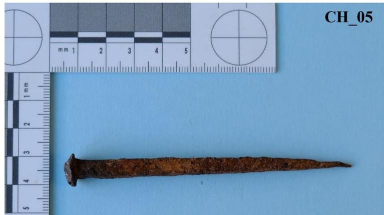
**Figura 2.8** Chiodo trattato con il protettivo metallay (CH\_05).
