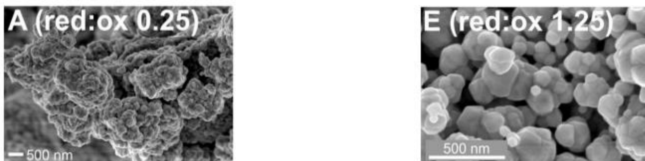
Figura 2.2. FESEM: immagine di campioni di \text{Co}_3\text{O}_4 ottenuti mediante la tecnica SCS con un rapporto di ossidazione \phi pari a 0.25 (A) ed a 1.25 (E) [48].
