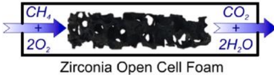
Figura 3.2: Reazione di combustione del metano su schiuma ceramica (tratta da [28] con modifiche).
