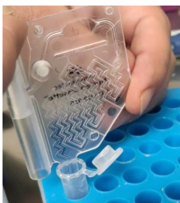
Figura 35-Prelievo del campione con la Nucleocassetta
