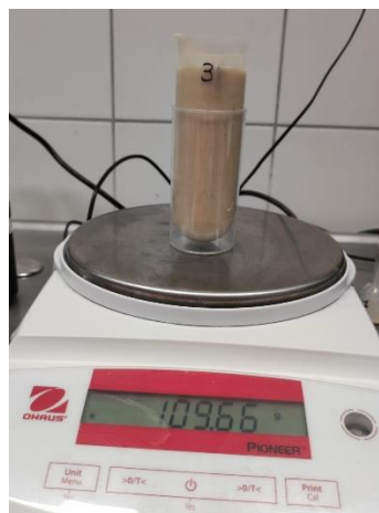
Figura 36-Peso campione di lievito prima della centrifugazione
