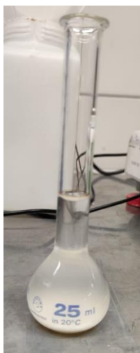
Figura 33-Matraccio da 25 ml contenete 1 grammo di campione di lievito e portato a volume
