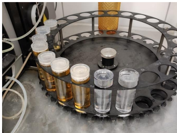
Figura 25-Ruota Paar da banco con 7 campioni da analizzare più le due provette di acqua distillata per il risciacquo finale
