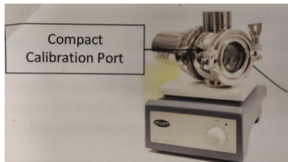
Figura 27- Compact Calibration Port durante il processo di taratura. Immagine tratta da [40] riportata con modifiche
