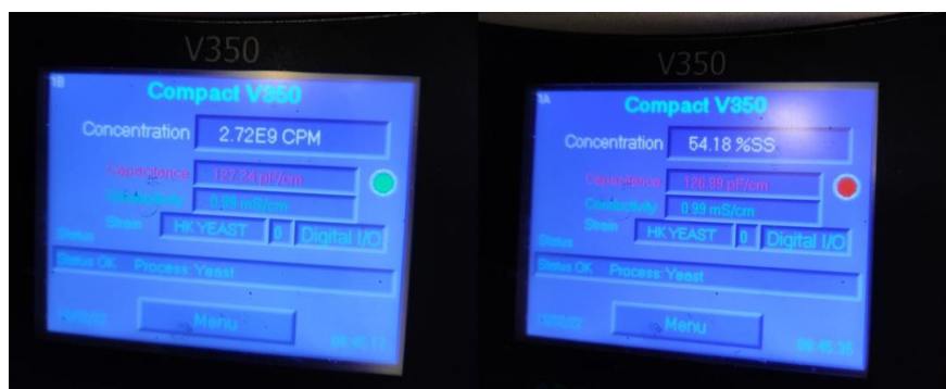
Figura 28- Schermo V350 Aber misura CPM vs misura %SS
