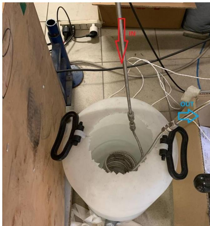
Figura 2.2.3, immagine serpentina della linea di raffreddamento del reattore
