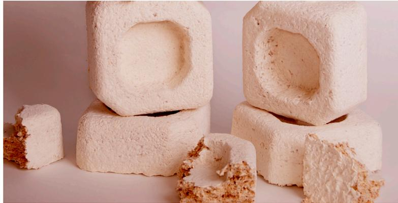
Si tratta di un'**applicazione specifica** della tecnologia MycoComposite di Ecovative. Risulta essere un materiale compostabile che utilizza il micelio come legante biologico auto assemblante per sottoprodotti agricoli. <sup>[9]</sup>
