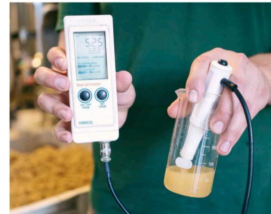
Figura 50. Phmetro per la misurazione dell'acidità nell'acqua.
