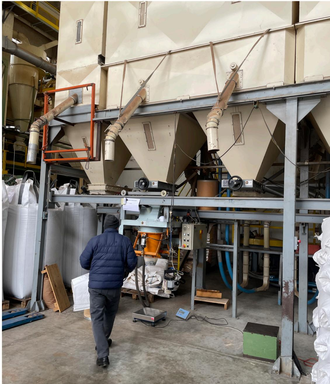
Figura 23. Impianto di micronizzazione. Fonte: foto dell'autore
