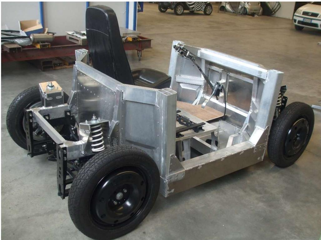
*Figure 1 - Risciò Rolling Chassis Back View*
