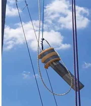
*Figura 2.8 Frame da video, dettaglio inclinazione grave durante il rimbalzo*
