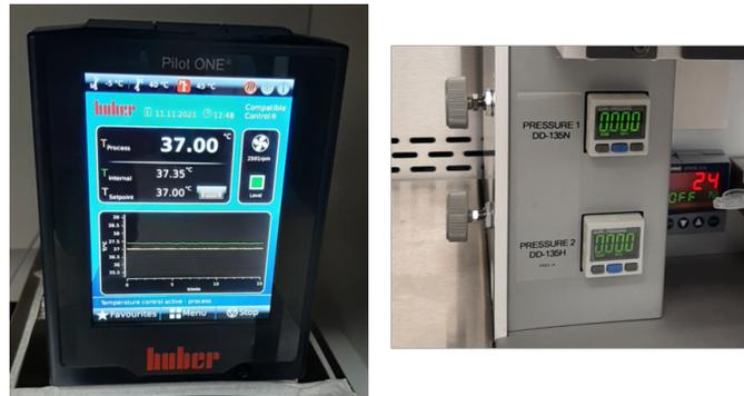
**Figura 3.23:** Dispositivi per il controllo manuale dalla temperatura e della pressione di stampa.
