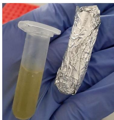
**Figura 3.6:** Soluzione di collagene e tioflavina, a pH acido, dopo la centrifugazione.
