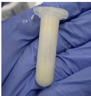
**Figura 3.5:** Soluzione di collagene e tioflavina, a pH acido, prima della centrifugazione.
