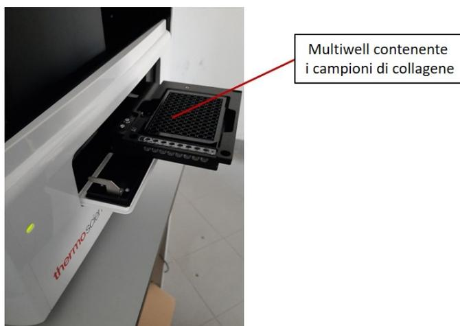
**Figura 3.8:** Lettura dello spettro di assorbanza della soluzione di collagene con il lettore di micropiastre multimode ad assorbanza.
