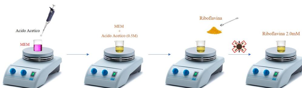
**Figura 3.9:** Preparazione della soluzione di riboflavina al 2 % w/v. Rappresentazione schematica dei passaggi operativi effettuati e degli strumenti e materiali utilizzati.
