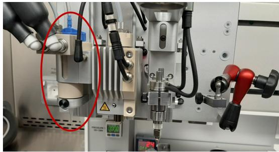
**Figura 3.19:** Modulo 1 per la stampa di idrogeli cellularizzati.
