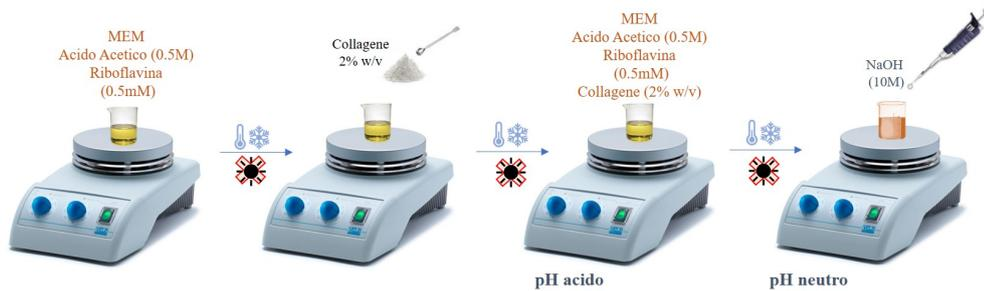
**Figura 3.10:** Preparazione della soluzione a base di collagene e riboflavina. Neutralizzazione della soluzione.
