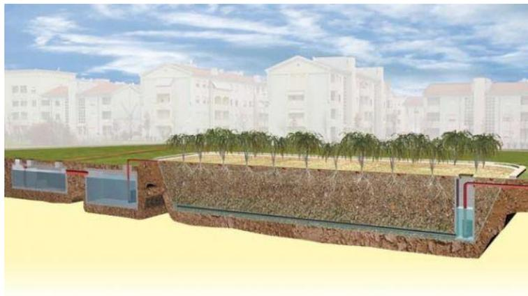
*Figura 26 Esempio sistema di fitodepurazione*
