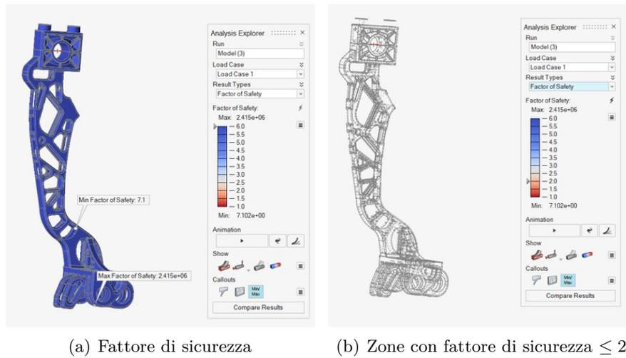
Figura 4.42. Fattore di sicurezza load case 1
