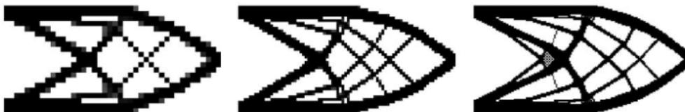
Figura 1.6. Cambiamento della topologia di una trave a sbalzo 2D al variare del numero degli elementi della mesh. A partire da sinistra: mesh 70x35, mesh 150x75, mesh 230x115 [13]
