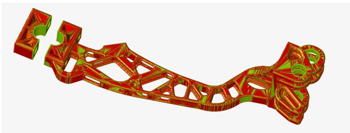
Figura 4.48. Sovrapposizione tra finito e grezzo di stampa provvisto di sovrapposti (zone completamente versati)
