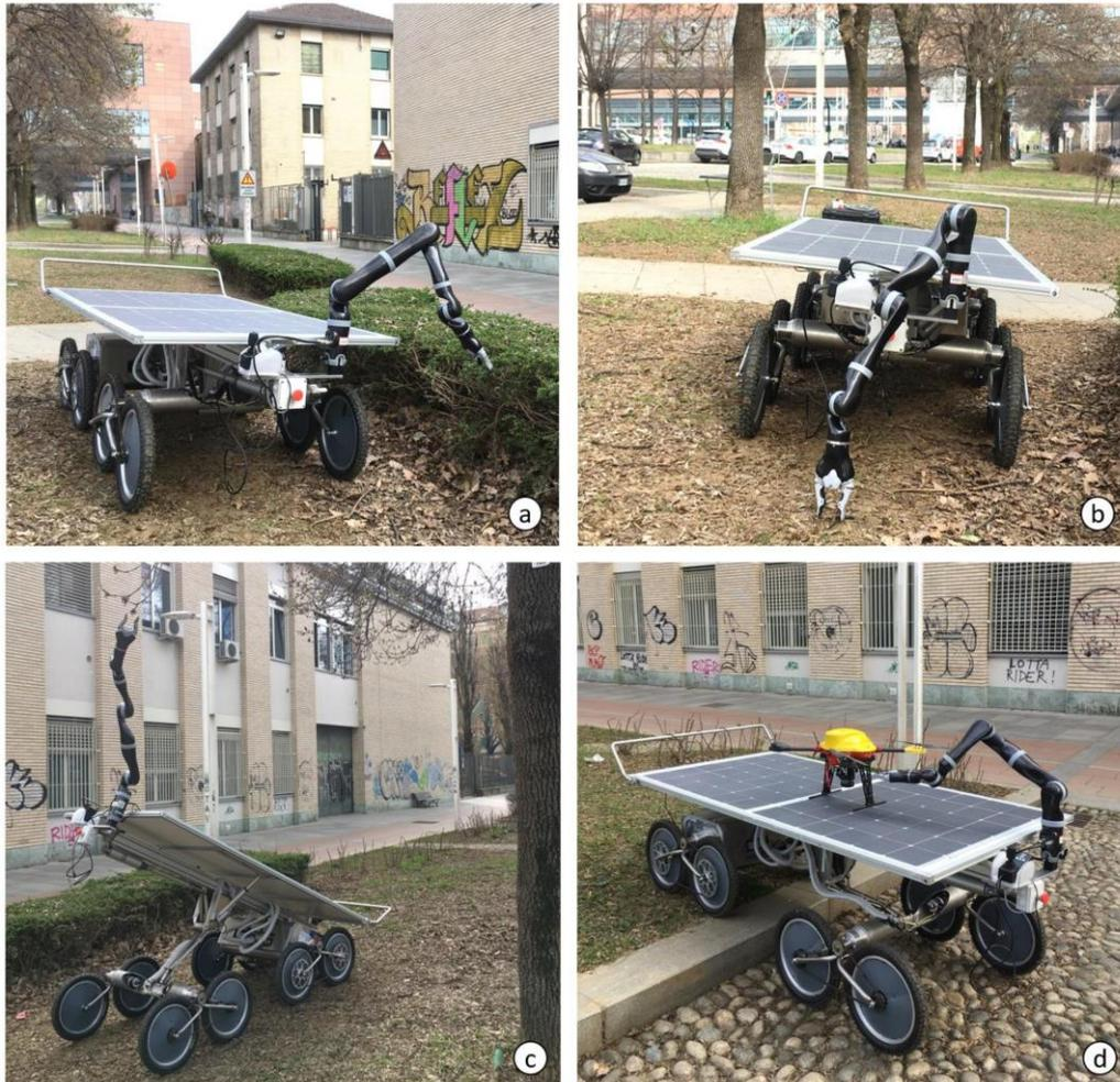
**Figura 1.7** Foto del veicolo Agri.q02 in differenti condizioni: (a) Braccio robotico a lavoro a lato del rover; (b) Braccio robotico che raccoglie campioni a terra; (c) Braccio robotico esteso con piattaforma azionata nella configurazione di massima altezza raggiungibile; (d) Interazione tra il braccio robotico e il drone atterrato sulla piattaforma.
