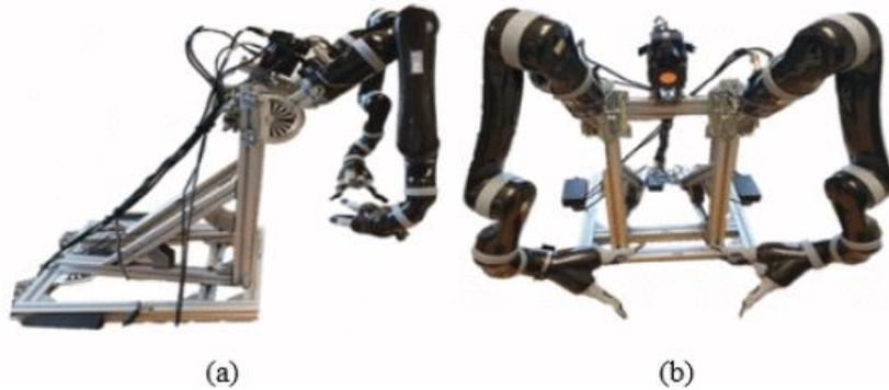
**Figura 1.4** Esempio di robot per la raccolta di melanzane [9].
