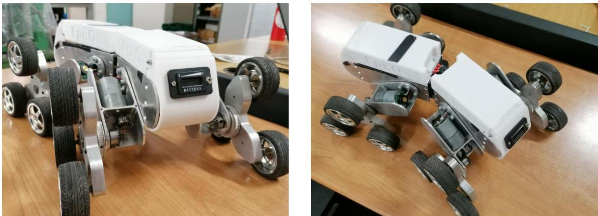
Figura 2.1 – Epi.Q, UGV modulare di sorveglianza, visto frontalmente (a sinistra) e dall'alto (a destra)
