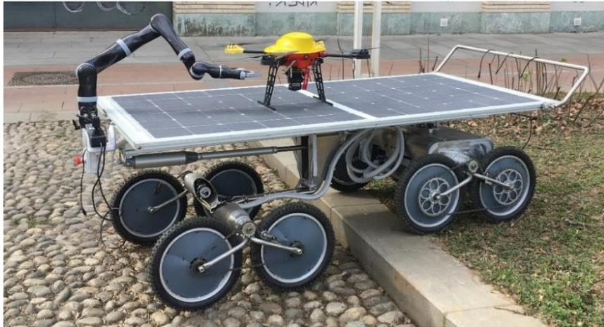
Figura 2.4 – Prototipo del robot mobile Agri.q
