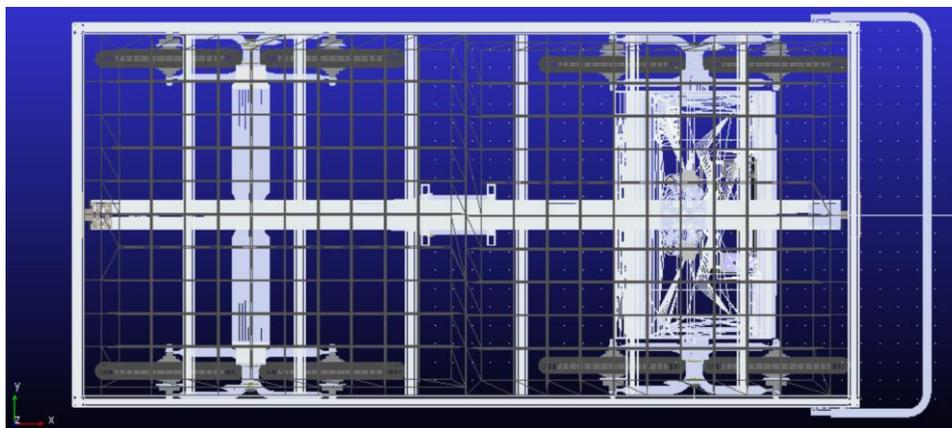
Figura 9.2 – Vista dall'alto del modello di Agri.q, il tipo di visualizzazione permette di vedere i moduli sotto il pannello solare
