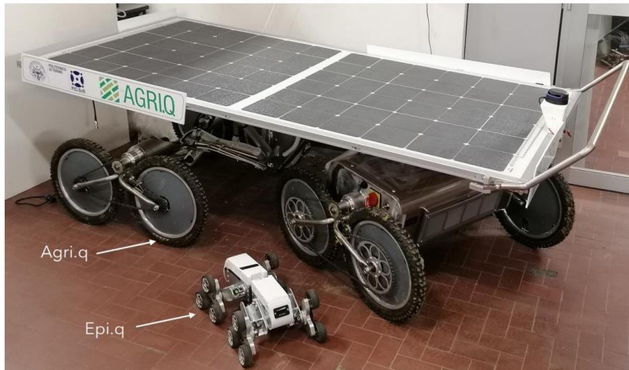
Figura 1.4 – I robot Epi.q ed Agri.q
