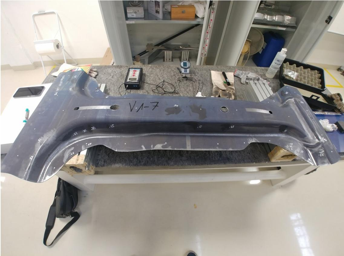
Figura 2.40. Montante centrale V1-7 su cui sono visibili i punti (bianchi) di presa delle misure di spessore e ulteriori misure direttamente sul pezzo. Si notano anche le zone carteggiate sul dorso e sull'aletta su cui prendere le misure di durezza.
