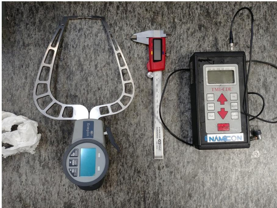
Figura 2.39. Attrezzature usate per la misurazione degli spessori nei componenti reali in Usibor 1500. Da sinistra: Comparatore a bracci Kroeplin C450, calibro elettronico e misuratore a ultrasuoni Namicon TM1-CDL.
