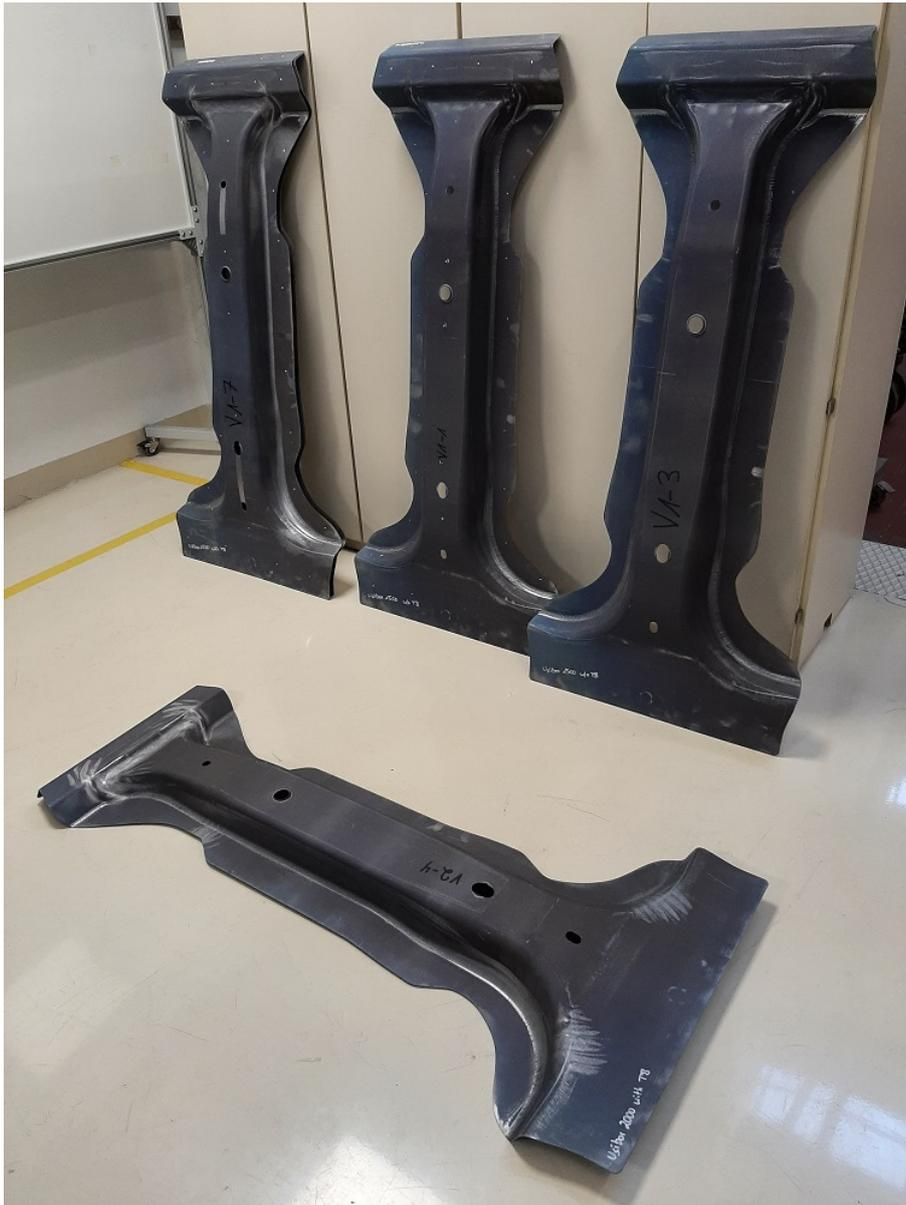
Figura 2.31. Componenti finali. Appoggiati agli armadi si notano i montanti centrali ottenuti con Usibor 1500 (sia con che senza trattamento di riscaldamento differenziato), mentre per terra un B-pillar ottenuto con Usibor 2000.
