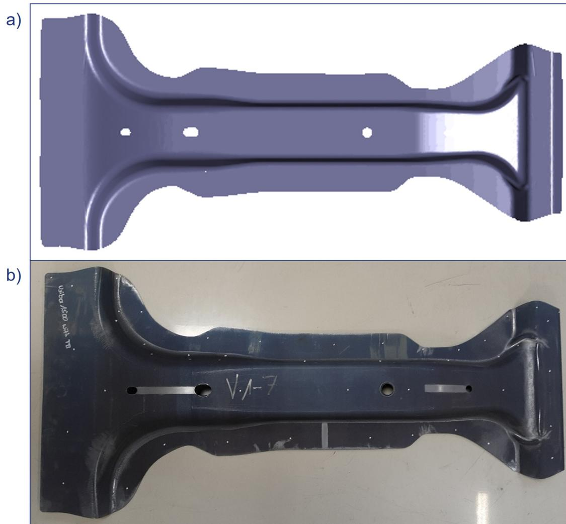
Figura 2.1. Vista superiore del componente preso in esame, sia del risultato della simulazione finale (a) e del componente reale (b).
