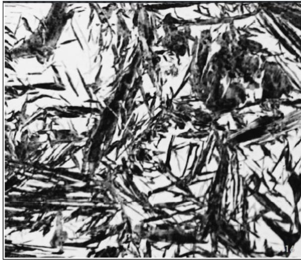
Figura 1.15. Microstruttura di un acciaio martensitico. [51]
