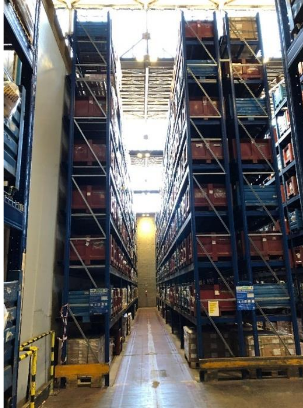
Figura 4.29-Un esempio di pallet posizionati a terra, causa non rispetto degli standard di imballo
