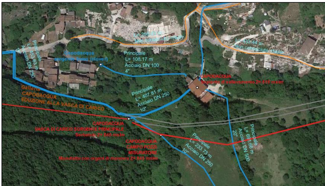
Figura 4 principali manufatti e condotte in corrispondenza di Capodacqua
