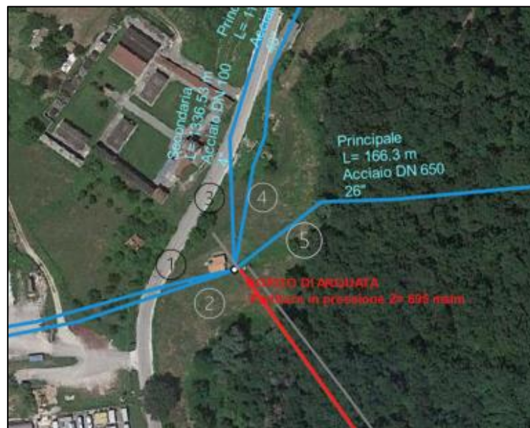
Figura 6 Partitore in pressione "Borgo D'Arquata"
