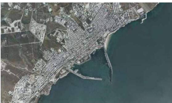
Figura 39. Esempio di porto con moli convergenti (Ligato et al., 2007).
