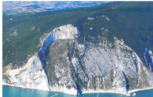
Figura 101. Scorrimento planare in prossimità della spiaggia "Due Sorelle", nel comune di Sirolo (Segato et al., 2011).
